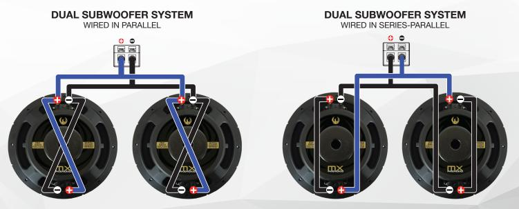
MX12D2 / MX10D2 = 1/2 OHM MX12D4 / MX10D4 = 1 OHM MX12D2 / MX10D2 = 2 OHM MX12D4 / MX10D4 = 4 OHM
