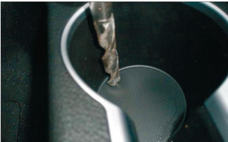
=> Bei Getränkehaltern mit festem Boden bohren Sie an geeigneter Stelle ein ca. 18 mm großes Loch zur Durchführung des USB-Anschlusskabels
