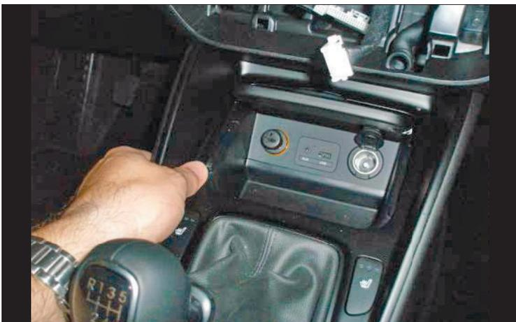
**Der Anschluss des Ladebeckers erfolgt verdeckt an das 12V Bordnetz**
