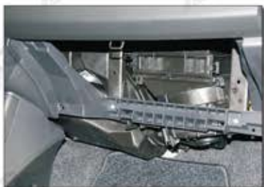
Otevřete odkládací schránku a vyjměte ji přitážením směrem k sedadlu.
