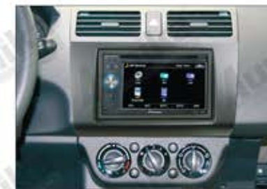
Připojte všechny konektory a anténní kabely. Zasuňte instalovanou jednotku až uslyšíte svaknutí zámku kovového rámečku. Sestavte rozebrané komponenty přístrojové desky v opačném pořadí.
