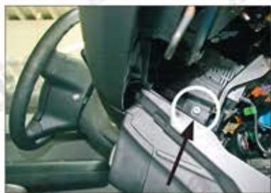
Odstraňte pojistnou matici z hlavní jednotky (strana spolujezdce pod palubní deskou).
