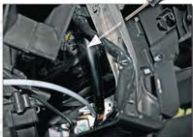
Odstraňte pojistnou matici z hlavní jednotky (strana řidiče pod palubní deskou). Umístěte šroubovák za rám, jak je znázorněno na obrázku.
