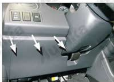
Vyjměte kryt přístrojové desky pod volantem, přitážením dolů směrem k sedadlu (viz. šipky)
